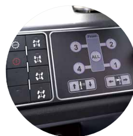
Steering control panel 转向控制面板
